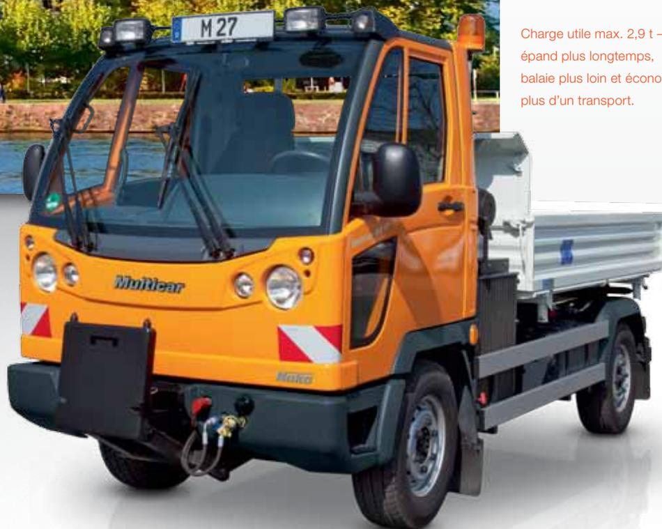
Le nouveau M27 T équipé d'une benne basculante à déchargement trilatéral.
