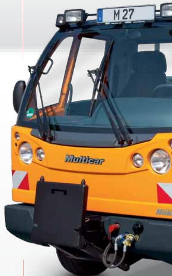
points d'emport robustes à l'avant, en haut et à l'arrière, système interchangeable éclair des équipements frontaux et montage avec système d'échange à boule pour une commande parfaitement économique car effectuée par une seule personne.
